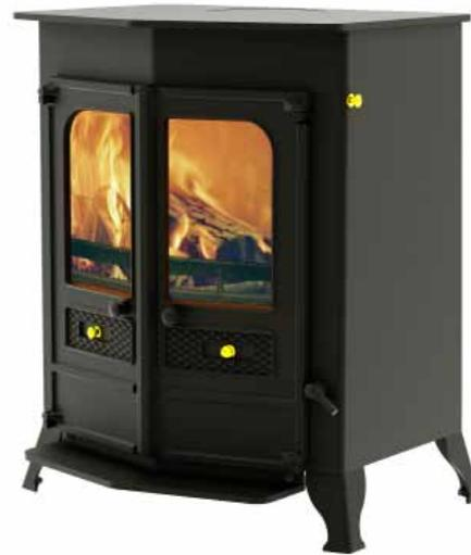
Le poêle à bois Country 16b est un appareil pour chauffage central biomasse. Il a une commande thermostatique et une puissance totale de 16kW: 8,6kW pour l'eau sanitaire et des radiateurs et 7,3kW pour la pièce. Ce modèle est adapté pour environ 7 radiateurs. Il dispose d'une grille multicombustible pour l'extraction facile des cendres, et de la technologie de combustion propre de Charnwood.
